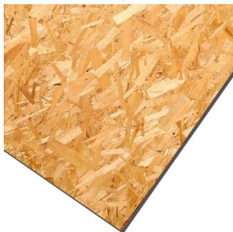
OSB está formada por varias capas de virutas de madera que son prensadas y unidas perpendicularmente con el objetivo de obtener más estabilidad o resistencia. OSB IMPORTADOS son tableros no estructurales Siendo ampliamente utilizados en la construcción de techumbres, muros y pisos, tanto en construcciones habitacionales y comerciales. También son usados en cierres perimetrales, instalaciones de faenas, partes y piezas de muebles, estanterías, Pallets y embalajes en general.
