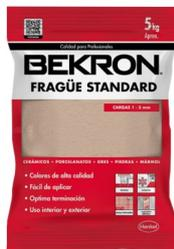
Mezcla a base de cemento, carbonatos y cuarzos finos, pigmentos micronizados y aditivos orgánicos usado para el relleno de las juntas entre cerámicos, porcelanatos y gres en paredes y pisos. • Fácil de aplicar. • Óptima terminación. • Cargas de 1 – 5 mm. Aspecto : Polvo fino Agua de amasado: 0,35 a 0,40 lt de agua por cada kilo Rendimiento\*: 0,4 a 0,5 kg/m2.
