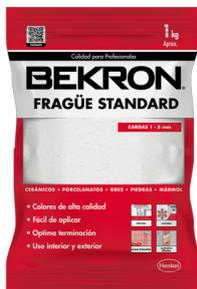
Mezcla a base de cemento, carbonatos y cuarzos finos, pigmentos micronizados y aditivos orgánicos usado para el relleno de las juntas entre cerámicos, porcelanatos y gres en paredes y pisos. • Fácil de aplicar. • Óptima terminación. • Cargas de 1 – 5 mm. Aspecto : Polvo fino Agua de amasado: 0,35 a 0,40 lt de agua por cada kilo Rendimiento\*: 0,4 a 0,5 kg/m2.
