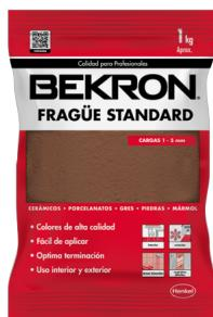
Mezcla a base de cemento, carbonatos y cuarzos finos, pigmentos micronizados y aditivos orgánicos usado para el relleno de las juntas entre cerámicos, porcelanatos y gres en paredes y pisos. • Fácil de aplicar. • Óptima terminación. • Cargas de 1 – 5 mm. Aspecto : Polvo fino Agua de amasado: 0,35 a 0,40 lt de agua por cada kilo Rendimiento\*: 0,4 a 0,5 kg/m<sup>2</sup>.
